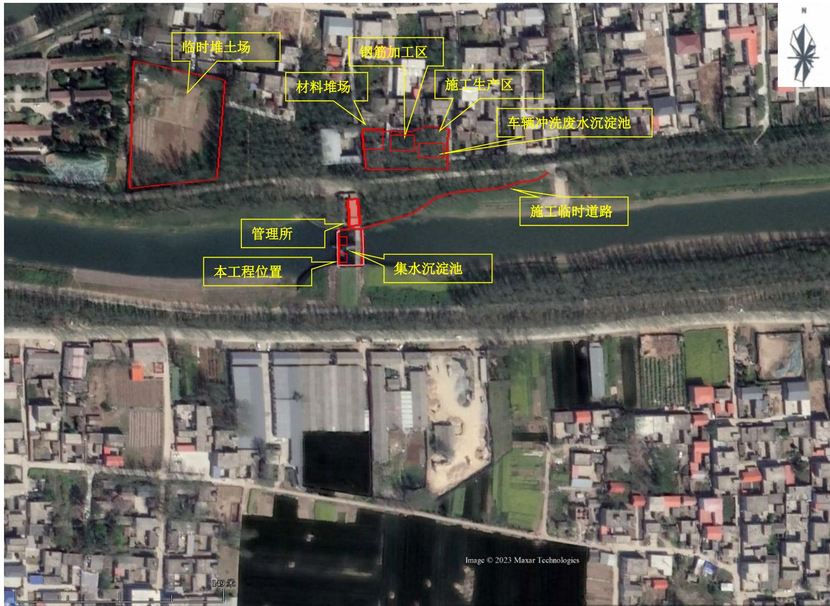
附图六 施工总平面布置图
