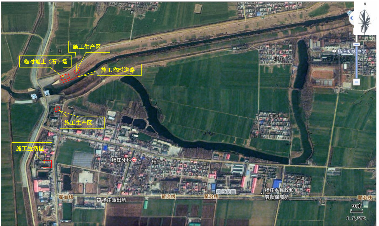
附图六 施工总平面布置图
