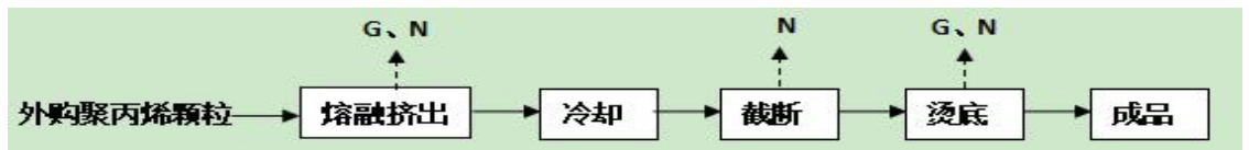
图 2-3 网兜生产工艺及产污流程图
