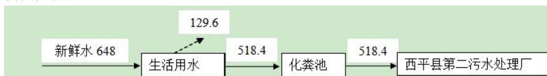
图 2-1 项目水平衡图 单位：m<sup>3</sup>/a
