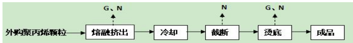
图 2-3 网兜生产工艺及产污流程图
