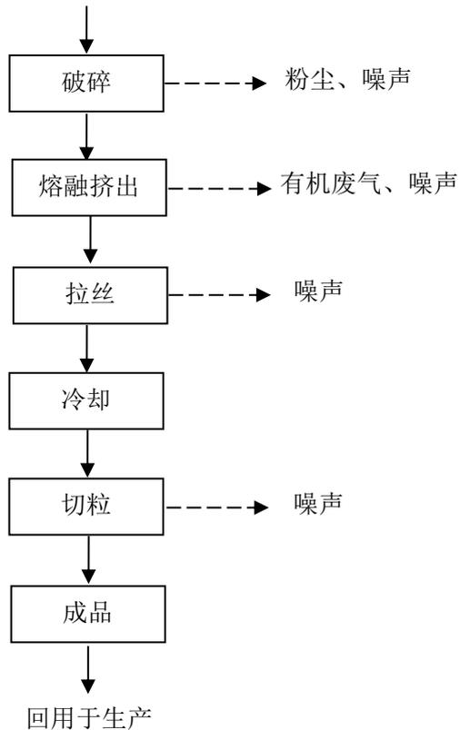
图 2-3 制粒生产工艺流程及产污环节图
