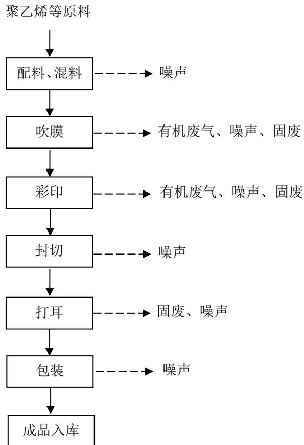
图 2-2 塑料袋生产工艺流程及产污环节图
