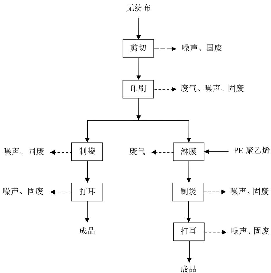
图 2-4 项目无纺布环保袋生产工艺流程及产污环节图
