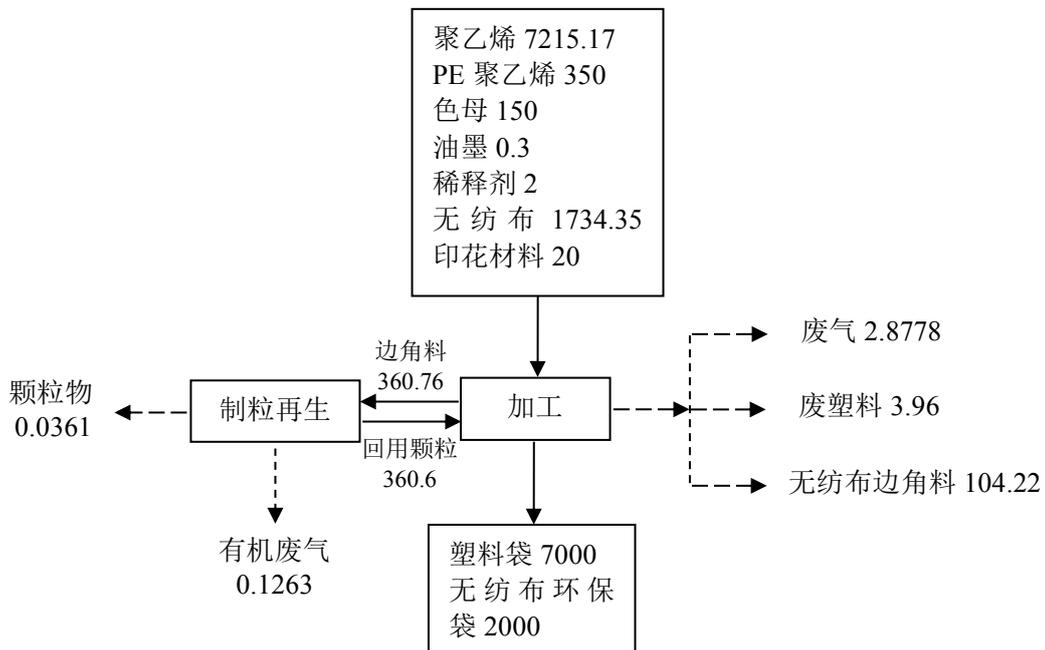
图 2-5 本项目物料平衡图 单位：t/a
