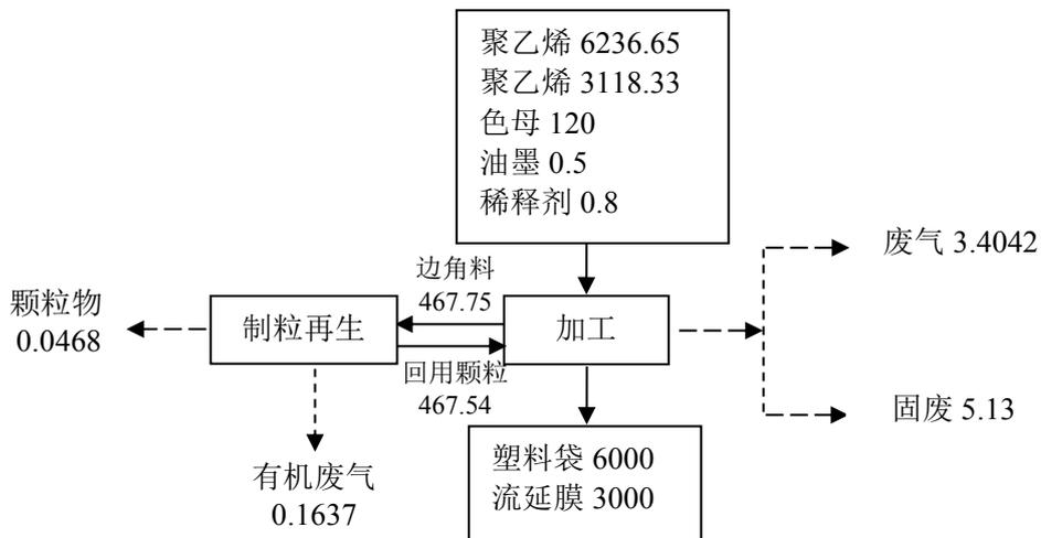
图 2-5 本项目物料平衡图 单位：t/a
