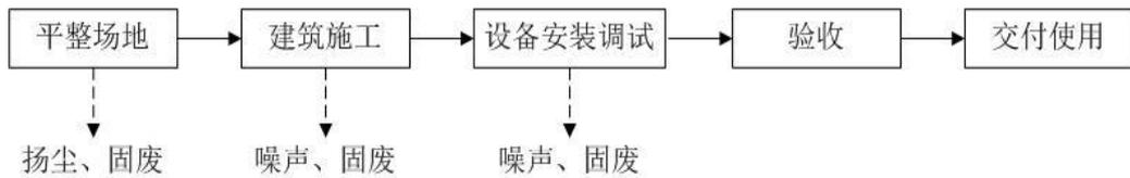
图 2-1 项目施工期工艺流程及排污节点图
