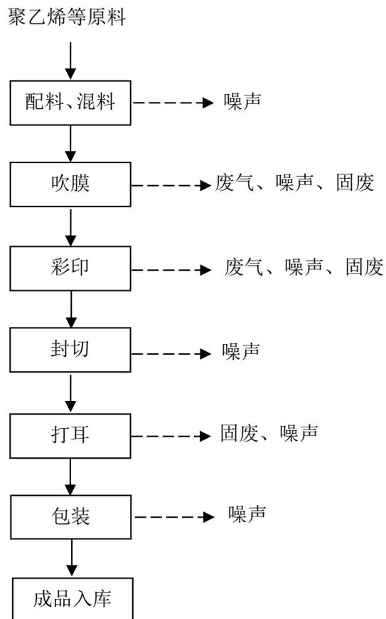
图 2-2 塑料袋生产工艺流程及产污环节图
