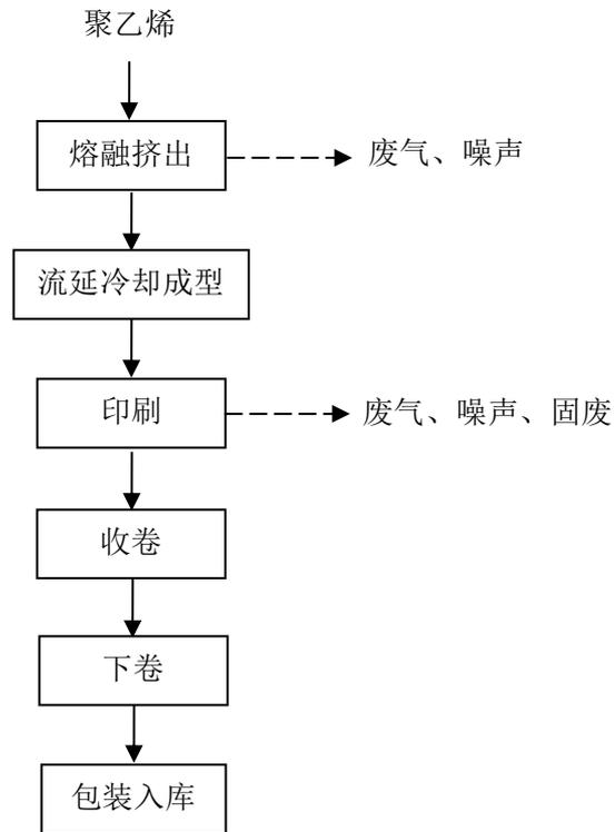
图 2-3 流延膜生产工艺流程及产污环节图
